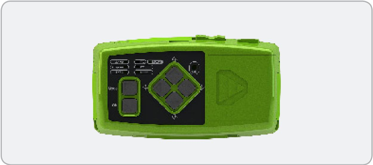
제어기 DRC 는 제어기 정면에서 Input / Output을 나타내는 버튼과 LED 가 있고, 측면에는 모터나 센서를 연결하는 포트 로 구성되어 있습니다. DRC 의 User Interface 는 정면의 버튼의 조작으로 제어기에 Input 명령을 할 수 있고, LED 를 통하여 Output 에 대한 데이터를 확인할 수 있습니다.
