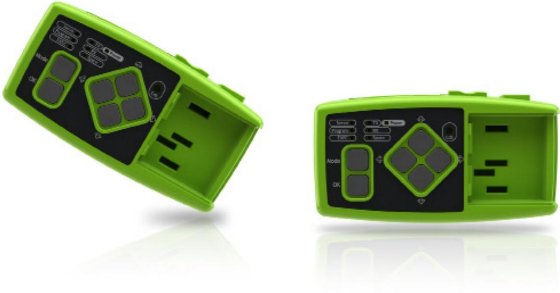
다시 DRC를 책상에 놓고 회전시키면 Z축을 회전축으로 하는 회전 각속도가 생깁니다. 자이로 센서는 회전 각속도를 감지해서 데이터로 변환 시킵니다. 반시계 방향으로 회전시키면 자이로 센서에서는 양(+) $z$ 축 각속도 값이 나오며, 시계 방향으로 회전시키면 반대로 음(-) $z$ 축 각속도 값이 나올 것입니다.
